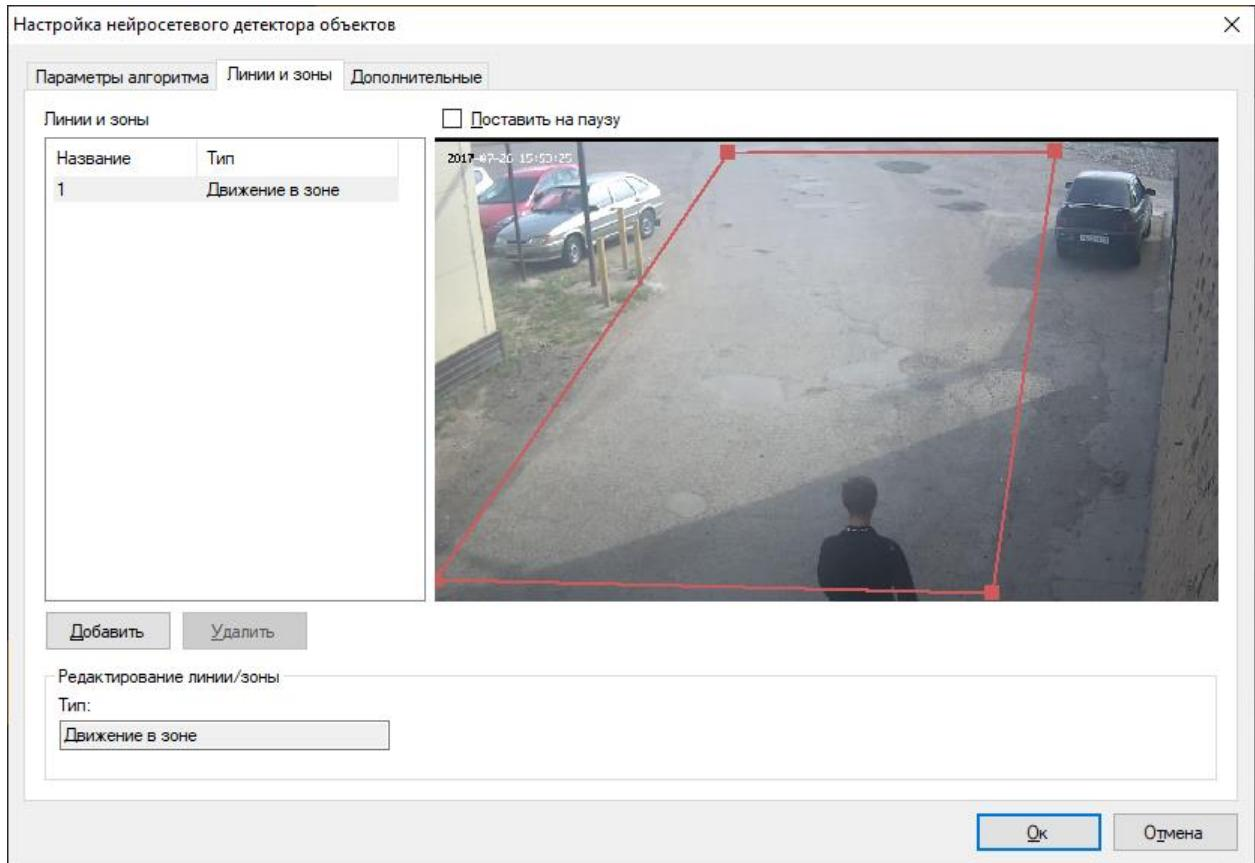
Если нажать на грань зоны ЛКМ, добавится дополнительная точка в виде заполненного прямоугольника. Пользователь может настроить зону индивидуально путем перетягивания данных точек. Ниже приведен пример интерфейса модуля с настроенной зоной.
