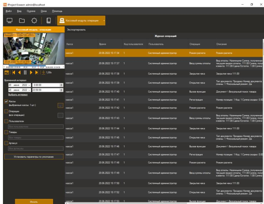
Данные со всех камер, на которых производится контроль кассовых операций возможно обрабатывать, используя специализированный режим «Кассовый модуль: операции»,
