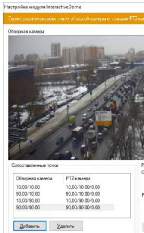
Для включения автоматического режима управления PTZ-камерой необходимо включить модуль «Отслеживание движущихся объектов» в настройках обзорной камеры.
