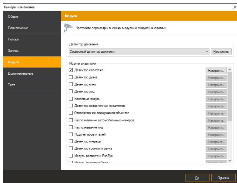
Обратите внимание, что модули работают в связке с серверным детектором движения, поэтому последний также должен быть включен.
