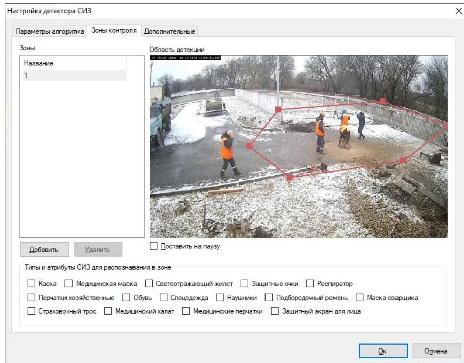
Если нажать на грань зоны ЛКМ, добавится дополнительная точка в виде заполненного прямоугольника. Пользователь может настроить зону индивидуально путем перетягивания данных точек. Ниже приведен пример интерфейса модуля с настроенной зоной.
