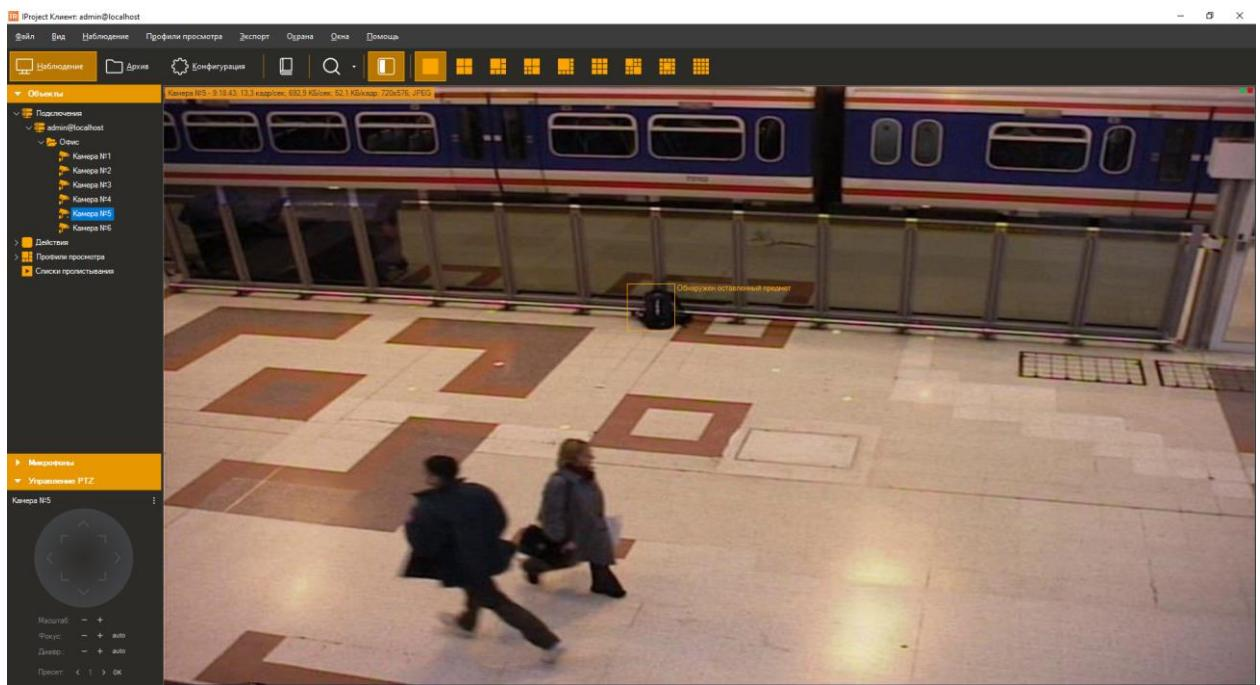
Если поставить камеру на охрану (меню «Охрана» -> «Режим охраны», настройка «Включить режим охраны»), то при срабатывании детектора будет производиться отображение тревоги. При этом, если видеопоток с камеры в данный момент отображается на экране, то видеоячейка с оставленным предметом будет обведена красным прямоугольником. Если видеопоток в данный момент невиден, то будет выведено всплывающее сообщение тревоги в журнал тревог.
