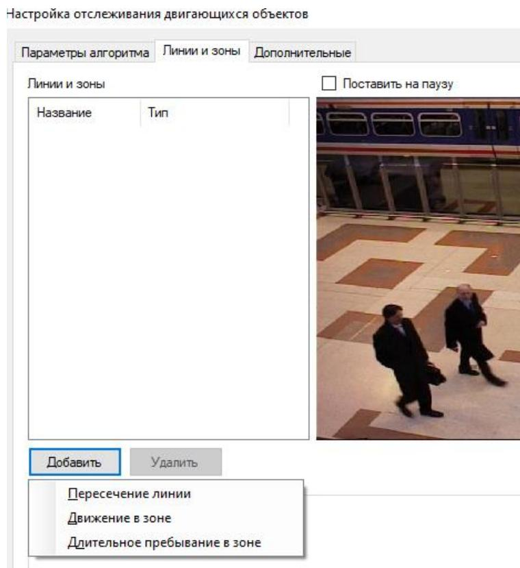
Задать отслеживаемое направление пересечения линии используя селектор «Направление».
