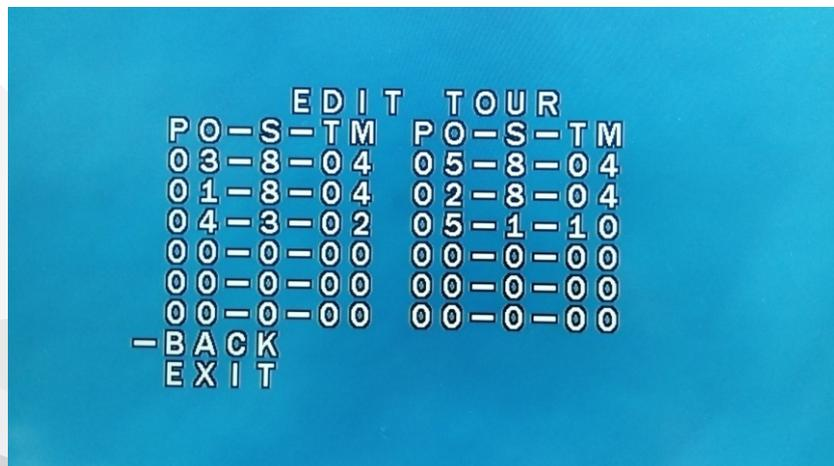
Где PO (point) – номер точки обзора, которую мы записали ранее, S (Speed) скорость передвижения между точками (есть 8 скоростей, чем ниже числовое значение, тем ниже скорость перехода) TM (Time) время, на которое камера задерживается в данной точке (в секундах).
