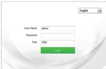
При первом входе на веб-интерфейс камеры, вам необходимо скачать плагин, закрыть браузер, после чего установить плагин. При повторном открытии интерфейса камеры, меню будет отображаться корректно.
