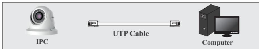
В данном примере показано подключение к IP-камере по заводскому IP-адресу.
