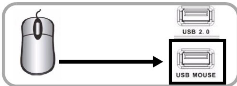
Рисунок 1.0 Подключение USB мыши в нижний разъем USB порта на задней панели.
