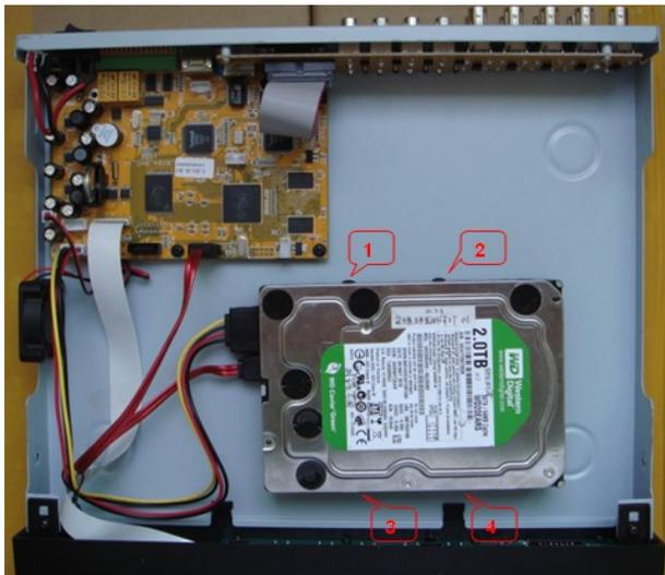
5. Зафиксируйте жесткий диск с нижней стороны с помощью винтов, одновременно придерживая его рукой, чтобы он оставался на защитных подушечках;
