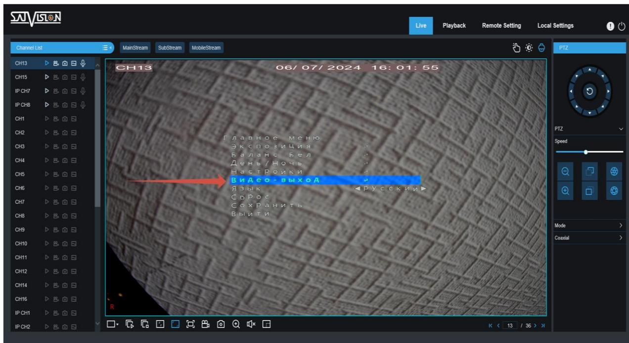
Далее в пункте HD нужно выбрать необходимый режим и нажать: если вы подключились через веб-интерфейс — диафрагма; если вы подключились через монитор, то нажать на центральную клавишу джойстика.
