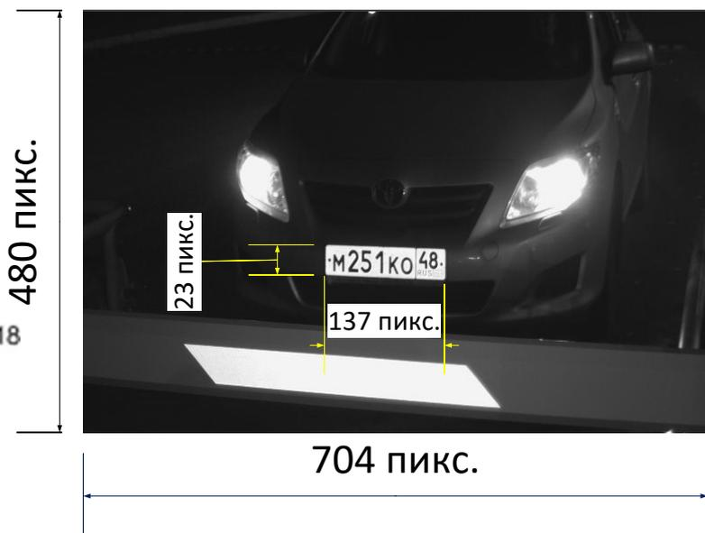
Исходя из того, что номерная пластина имеет размер 520x112 мм, а изображение номера должно быть не меньше 80x18 пикселей легко посчитать требуемое разрешение видеокамеры (по горизонтали):
