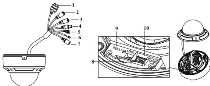
1. Разъем RJ-45 для LAN соединения.
