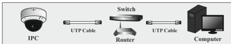
1. Убедитесь, что камера и компьютер подключены по локальной сети с помощью UTP кабеля.
