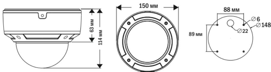
2. Закрепите монтажное основание с камерой к стене с винтами, как показано ниже:
