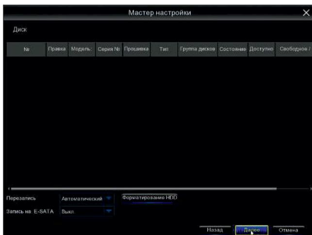
В данном разделе, вы можете ознакомиться с номером подключенного к системе HDD, и его состоянием. А также, система показывает время непрерывной записи. Есть возможность установить функцию перезаписи.
