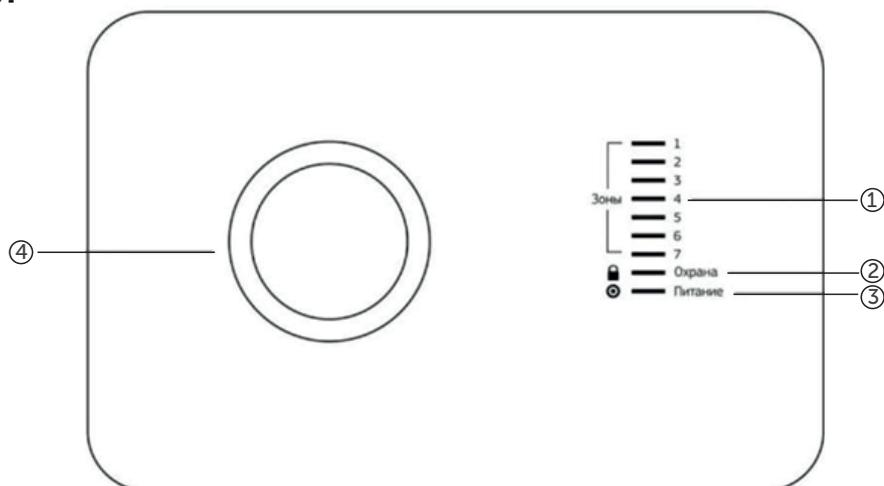
1. Световой индикатор защитных зон: загорание светового индикатора указывает на срабатывание зоны.
